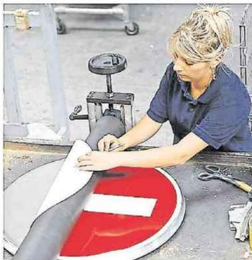
Les motifs sont confectionnés dans l'atelier de sérigraphie. Puis collés à la main sur des supports en alu usinés sur place
