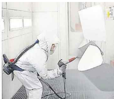
Le service conception dessine les panneaux (à gauche). Le mât signe la fabrication en série commence. De la poudre colorée est pulvérisée avant passage au four.
