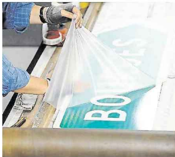
Les motifs sont confectionnés dans l'atelier de sérigraphie. Puis collés à la main sur des supports en alu usinés sur place
