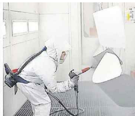
Le service conception dessine les panneaux (à gauche). Le marche signé, la fabrication en série commence. De la poudre colorée est pulvérisée avant passage au four.
